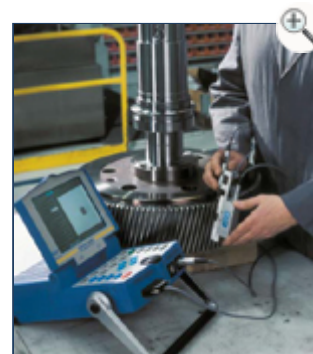
Рис. 4. Дефектоскоп «ELOTEST B300» в работе.
